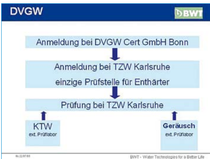
Bild 2 Formaler Ablauf der Zertifizierung eines Trinkwasser-Enthärters durch den DVGW
